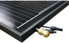
**PVT-KOLLEKTOR:** Hinter dem PV-Modul ist ein Rohrregister montiert, das mit einem Wärmeträger durchflossen wird. Dieser thermische Absorber nimmt die Abwärme der Photovoltaik-Module und die Umgebungswärme auf und stellt sie der Wärmepumpe als Wärmequelle zur Verfügung.
