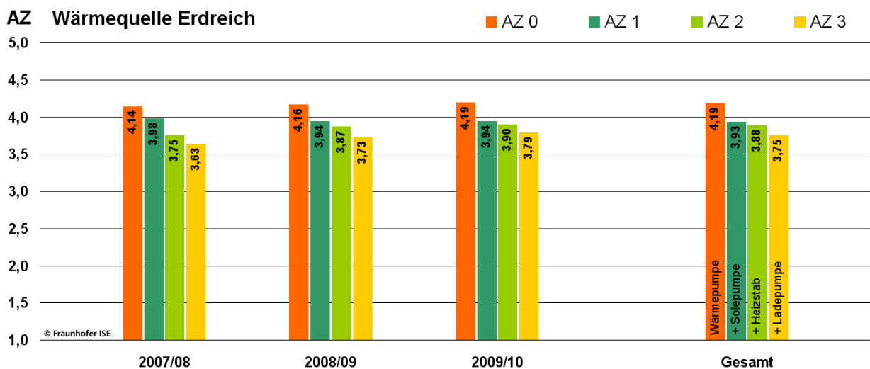
Bild 14: Arbeitszahlen von Erreich-Wärmepumpen in verschiedenen Zeitperioden im Betrachtungszeitraum Juli 2007 bis Juni 2010 unter Berücksichtigung vier verschiedener Bilanzgrenzen (Erläuterung in Kapitel 5.1)
